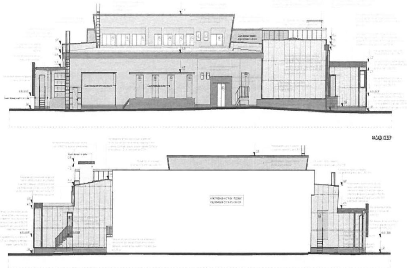
Основната носеща конструкция на сградата е стоманобетонна монолитна. Основите са стоманобетонни, със ст.б. стени по контура и настилка на кота ±0,00, която е повдигната над терена на около 1,20м, като по този начин са оформени товарни рампи за товарене и разтоварване на камиони.
